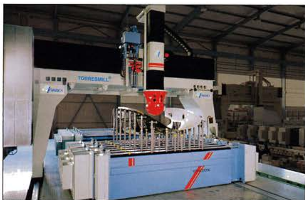
TORRESMILL trabajando sobre una pieza sujeta mediante TORRESTOOL.
