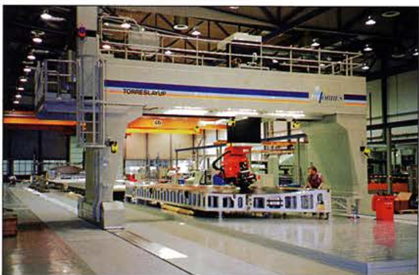
TORRESLAYUP para materiales compuestos.
