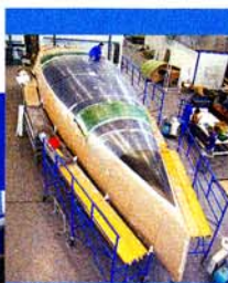
Midiendo sobre el casco para fabricar la cuna del barco
