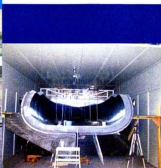
Dentro del horno para efectuar el curado de la fibra de carbono.
