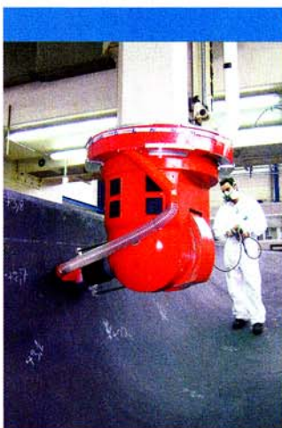
Fresando el molde hembra con fresadora por control numérico.
