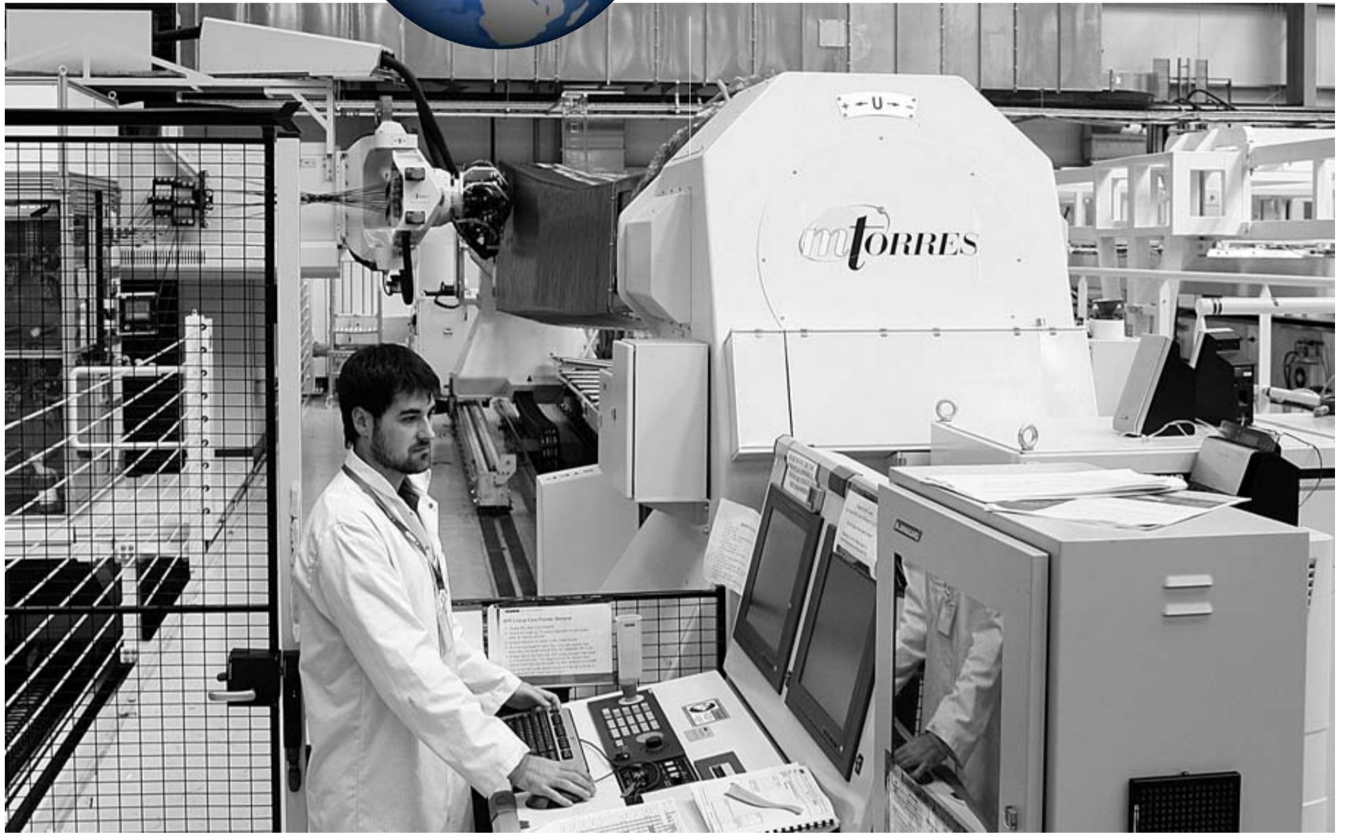
EN SU PUESTO DE TRABAJO. En la sala limpia de la fábrica, con una de las máquinas con las que GKN produce las piezas estructurales de las alas (spars) del proyecto Airbus A350.
