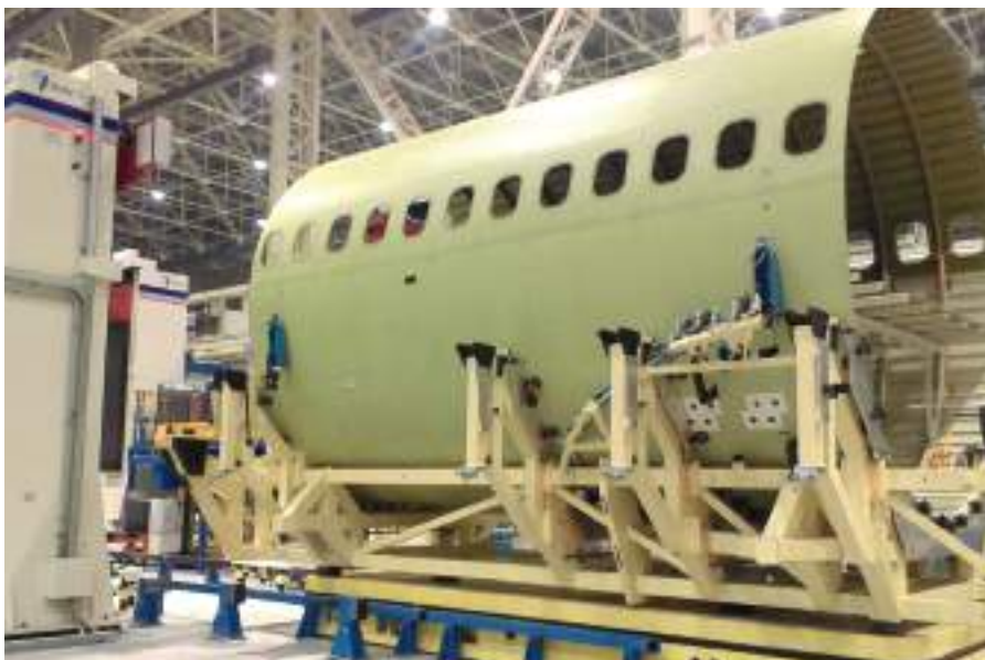
Maquinaria de MTorres en la línea de ensamblaje del avión C919.
