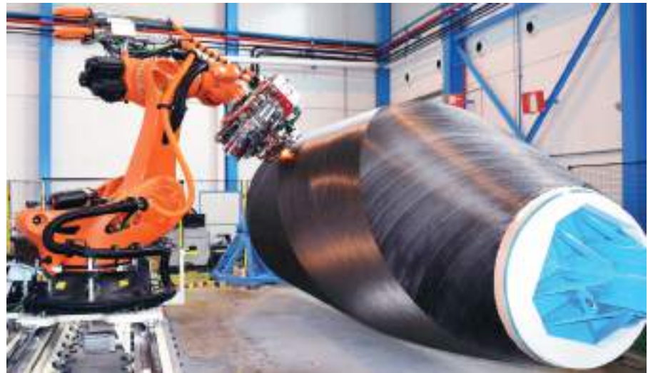
Nuevo proceso de fabricación automatizada sin molde para fuselajes monocasco en material compuesto desarrollado por MTorres.
